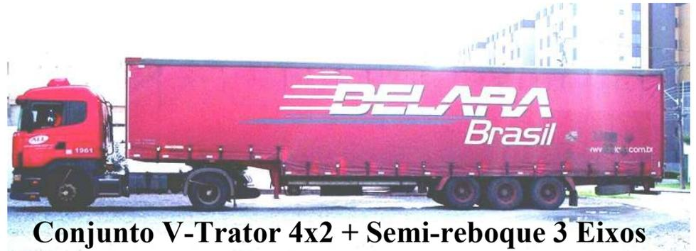
Conjunto V-Trator 4x2 + Semi-reboque 3 Eixos
