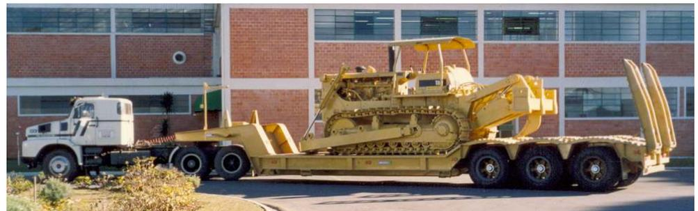
Conjunto V-Trator 6x2 ou 6x4 + Semi-reboque 3 Eixos
