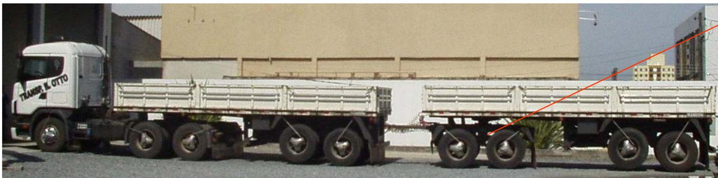
**Conjunto do Tipo Rodotrem (4 veículos, 9 eixos e PBT de 74 ton)**
