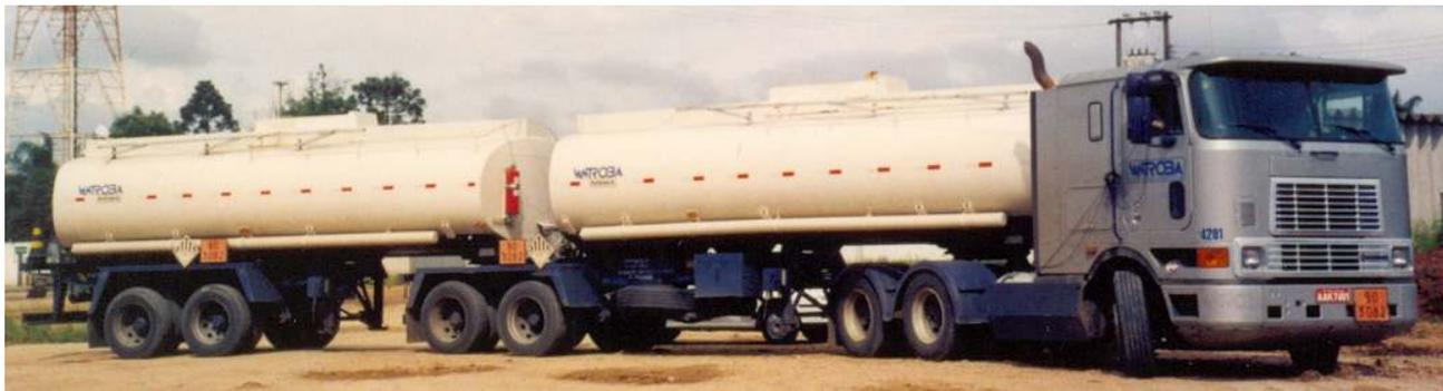
**Conjunto do Tipo Bitrem - (3 veículos, 7 eixos e PBT de 57 ton)**
